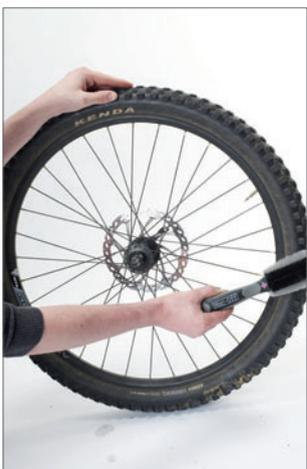
**7** Lavez les pneus en utilisant une brosse dure pour ôter la boue des sillons. Si vous avez des freins V-Brakes, ôtez la poussière noire des freins et vérifiez l'usure des jantes. Utilisez un liquide de nettoyage pour freins à disque à base d'alcool et évitez de répandre de la graisse avec les brosses que vous avez utilisées pour la cassette.
