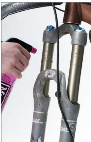
**8** Soyez prudents en nettoyant les fourches: ne pulvériser pas le dégraissant directement sur les joints et nettoyez-les avec une éponge plutôt qu'avec une brosse dure. Prenez garde à ne pas laisser les produits pénétrer à l'intérieur des fourches: ils risqueraient d'entraîner l'apparition de points de corrosion.
