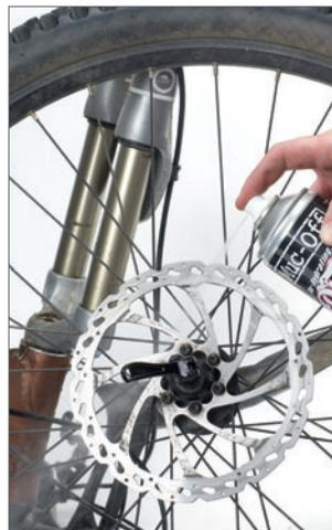
**10** Soyez attentif aux disques de frein, car ils peuvent être souillés par l'huile et des résidus de lubrifiant de la transmission. Utilisez une brosse propre et de l'eau pour les nettoyer à fond. Avec les freins V-Brakes, il faut retirer toutes les saletés des patins et vérifier la présence de sable collé dans les rainures. Inspectez les jantes pour repérer l'usure liée aux patins.
