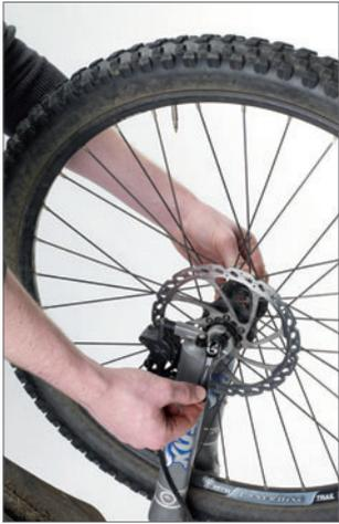
**3** Retirez les deux roues, qui sont bien plus faciles à nettoyer séparément. Cela vous donnera accès à l'intérieur du triangle arrière et au bras oscillant, et vous permettra de retourner facilement le vélo sur le trépied.
