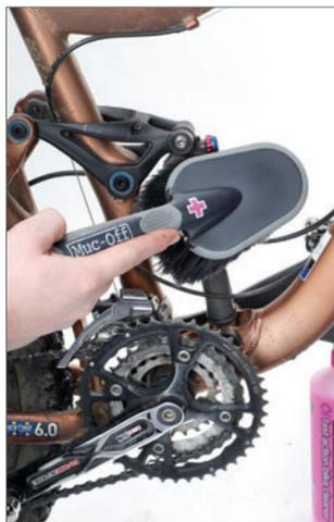
**9** Les suspensions arrières peuvent accumuler des dépôts de boue qui risquent de corroder et de gripper les pivots. Nettoyez-les avec une brosse sèche de manière à prévenir toute coulée d'eau à l'intérieur des tubes. Profitez-en pour inspecter les amortisseurs à la recherche de fuites et des signes d'usure.
