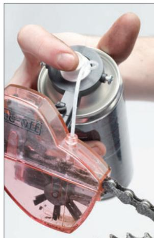
**4** Maintenez le nettoyeur de chaîne et tournez les pédales. Quelques cycles suffisent pour obtenir une chaîne immaculée. Pensez à lubrifier avant de reprendre la route.
